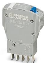
Disjuntor de proteção de equipamentos termomagnético, 1 polo, curva característica de disparo SFB, 1 contato inversor, conector plugável para elemento básico.
