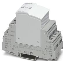
Proteção de equipamentos plugável, conforme tipo 3/classe III, para redes de fornecimento de energia trifásicas com N e PE separados (sistema de 5 condutores: L1, L2, L3, N, PE), com fusível à prova de corrente de surto integrado e contato de sinalização remota.
