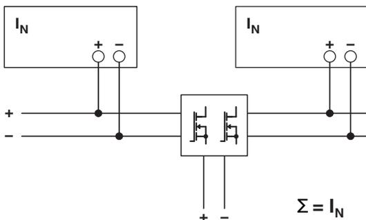
Bild 47 Prinzipdarstellung, Redundanzbetrieb mit QUINT S-ORING
