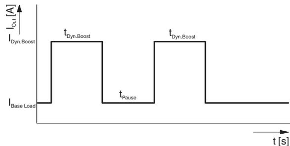
Mit Hilfe der folgenden Tabellen ermitteln Sie die erforderliche Erholzeit ( $t_{\text{Pause}}$ ) bei maximalem dynamischen Boost-Strom ( $I_{\text{Dyn. Boost}}$ ) abhängig von den Werten:
