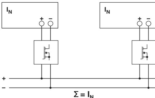
Für die Projektierung der Sperrflächen gelten im Redundanzbetrieb bestimmte Vorgaben. Im Redundanzbetrieb werden die Stromversorgungen mit maximal halber Nenn-
