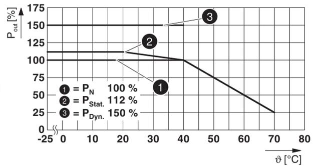
16.4.5 Einbaulage gedreht 90° X-Achse
