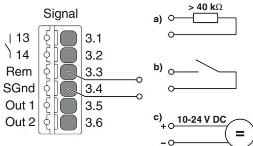
Um die Stromversorgung bei Verwendung von einem SPS-Ausgang in den SLEEP MODE zu schalten, wählen Sie folgende externe Beschaltungsvariante.
