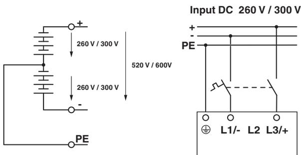
Schalten Sie bei DC-Anwendungen eine für die Betriebsspannung zugelassene Sicherung vor.
