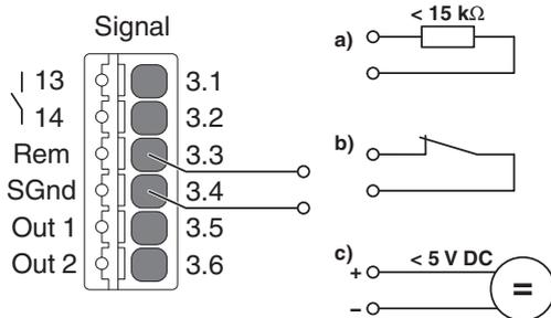
Um die Stromversorgung wieder einzuschalten, wählen Sie eine der nachfolgenden externen Beschaltungen zwischen den Signalklemmen Rem und SGnd. Die geräteinterne Leistungsübertragung wird erneut aktiviert. An den DC-Ausgangsklemmen steht wie gehabt die Energie zur Lastversorgung zur Verfügung.
