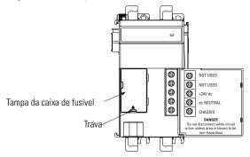
Substitua o fusível de acesso frontal, centrando o fusível de substituição sobre o clipe de fusível e pressionando para baixo.
